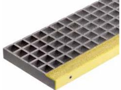
I laminati in PRFV possono essere forniti con superficie **antisdrucciolo** con quarzo certificata secondo norma DIN 51130 ed essere sagomati e tagliati a misura. In colore standard grigio, possono essere realizzati anche in altri colori. Sono utilizzati come elementi di tamponamento e di copertura di piani di camminamento.
