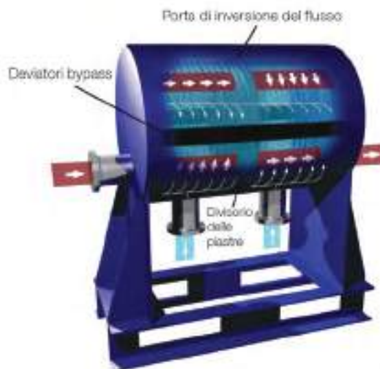
Schema di flusso di un AlfaDisc a passaggio multiplo.
